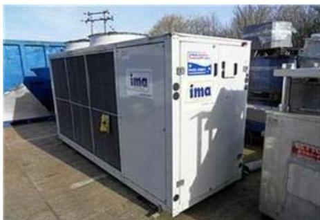
Una pompa di calore ad alta temperatura (nella foto in un'immagine di repertorio) in grado di produrre acqua calda superiore ai 75°C, e capace di sostituire le attuali caldaie da riscaldamento senza la necessità di rifare completamente l'impianto.
